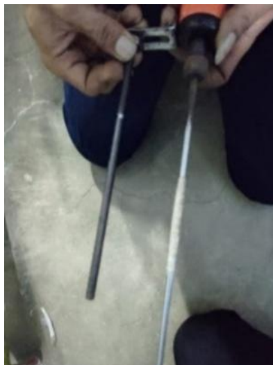
Gambar 3.5 cleaning roll model baru dengan menggabungkan dua plate besi
